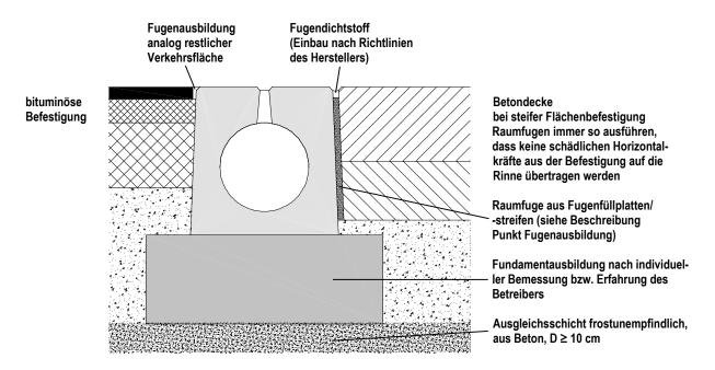
Gründung auf frostunempfindlichen Boden (F1), Steifeziffer Baugrund E₅ ≥ 60 MN/m², Materialien und Verdichtungswerte Baugrund nach den einschlägigen Regelwerken des Straßen- und Verkehrswegebaus entsprechend der Bauklasse und Bauart der Verkehrsfläche.
